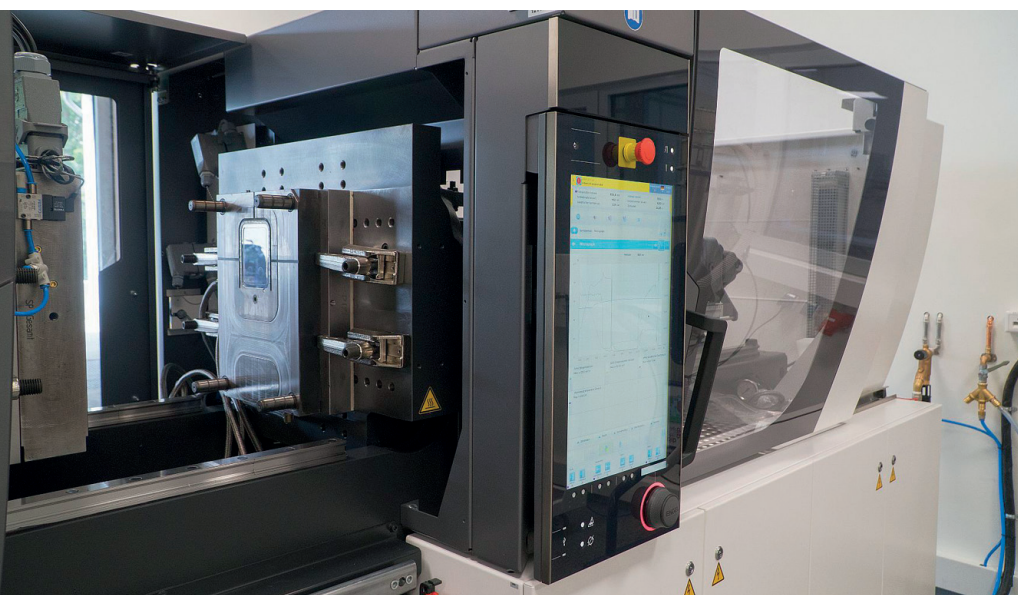
Bild 4: Als erster Spritzgießmaschinen-Hersteller hat ENGEL das Z-System in einer seiner 80-Tonnen-SGM steuerungstechnisch integriert. Eine solche Maschine bildet das technologische Herzstück des neuen SIT von hotset
