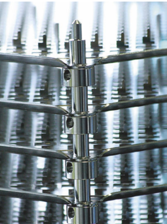
Mehrebenen-Werkstückträger aus elektropoliertem Edelstahl, exklusiv entwickelt und gefertigt für den Einsatz in einer Elektroproduktion
